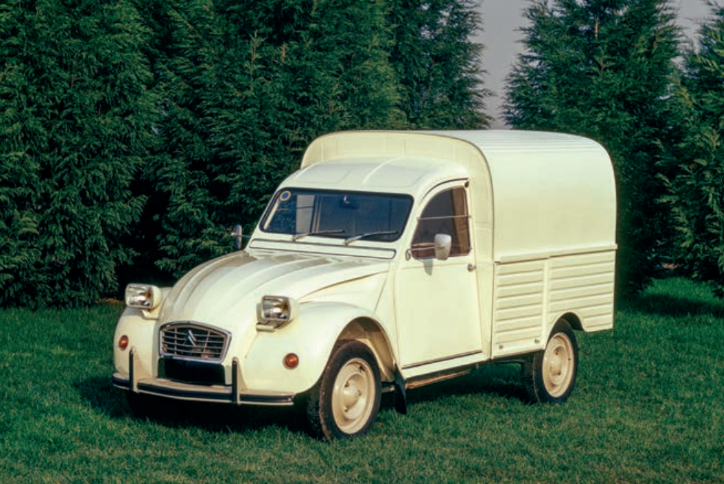
Sopra, a sinistra, la 2CV AKS nell'ultima configurazione del 1974, con capacità di carico di 400 kg. I vetri laterali sono soppressi e offerti solo a richiesta. A destra, la Cimos Dak, prodotta su licenza in Jugoslavia. Ha il passo della berlina ed è diverso il lamierato del tetto. Sotto, la versione Pick-up semiufficiali realizzata nel 1982 da una filiale Citroën, la ENAC. A destra, l'ultima brochure pubblicitaria della Acadiane, che rimane in commercio ancora fino al 1987, affiancando la sua sostituta C15 su base Visa presentata nel 1984.
