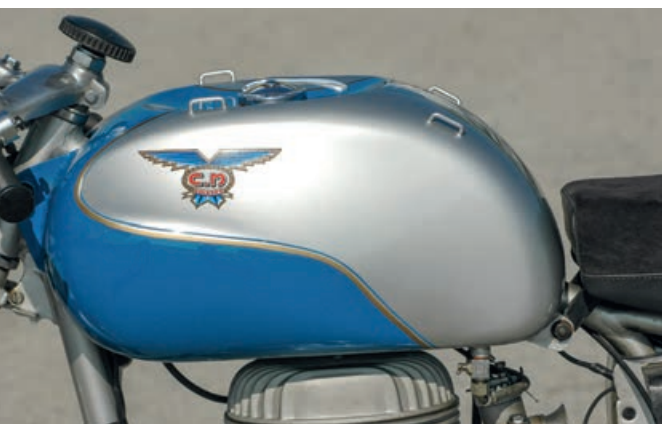
La Sport si distingue anche per il serbatoio da 15 litri di maggior capacità.
