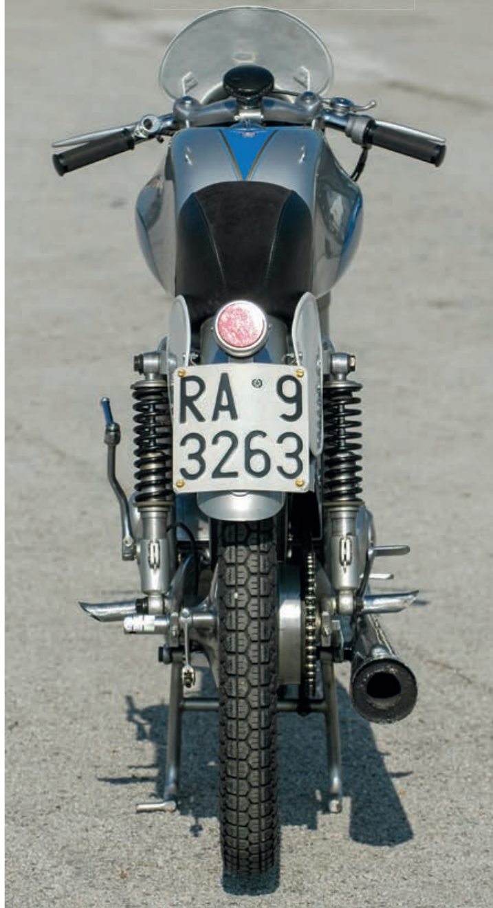
Dietro troviamo il classico forcellone oscillante con due gruppi molla-ammortizzatore racchiusi in foderi in lamiera. Quest'ultima soluzione diviene comune su tutte le C.M. a partire dal 1952 e sostituisce la sospensione a brevetto C.M.
