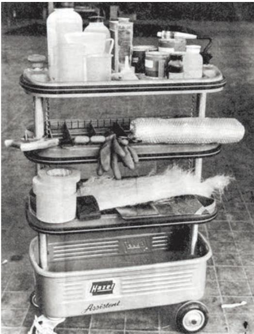
Il carrellino con le materie prime e le attrezzature necessarie per la riparazione della carrozzeria della Stellina. Progettato dall'ing. Luigi Fabio Rapi insieme con la vettura, era fornito alla rete di assistenza Autobianchi unitamente a un dettagliato manuale di istruzioni.
