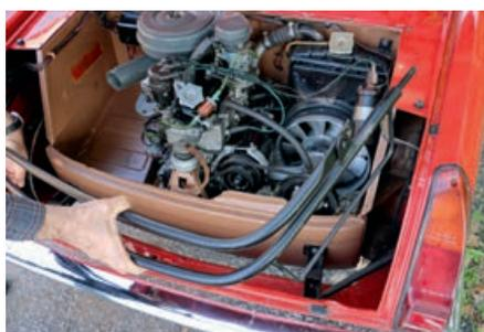
Da sinistra, lo sportello, nella paratia interna dietro i sedili, per accedere al motorino di avviamento. Le manovre di alloggiamento della struttura della capote nell'apposito vano posteriore alla base del motore.
