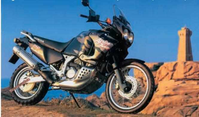
del 1988 ma la meccanica è ora, molto diversa: la moto è mossa da un bicilindrico parallelo frontemarcia compatto e ottimizzato nell'erogazione, di 998 cm<sup>3</sup>, in grado di erogare 95 CV, dotata di testata Unicam, piuttosto sopraelevato da terra, rispetto alle concorrenti, per tornare a superare ostacoli impegnativi e fuoristrada notevoli. Dove invece nonna e nipote aderiscono, è nella leggerezza - la CRF pesa come la XRV nonostante una cilindrata
