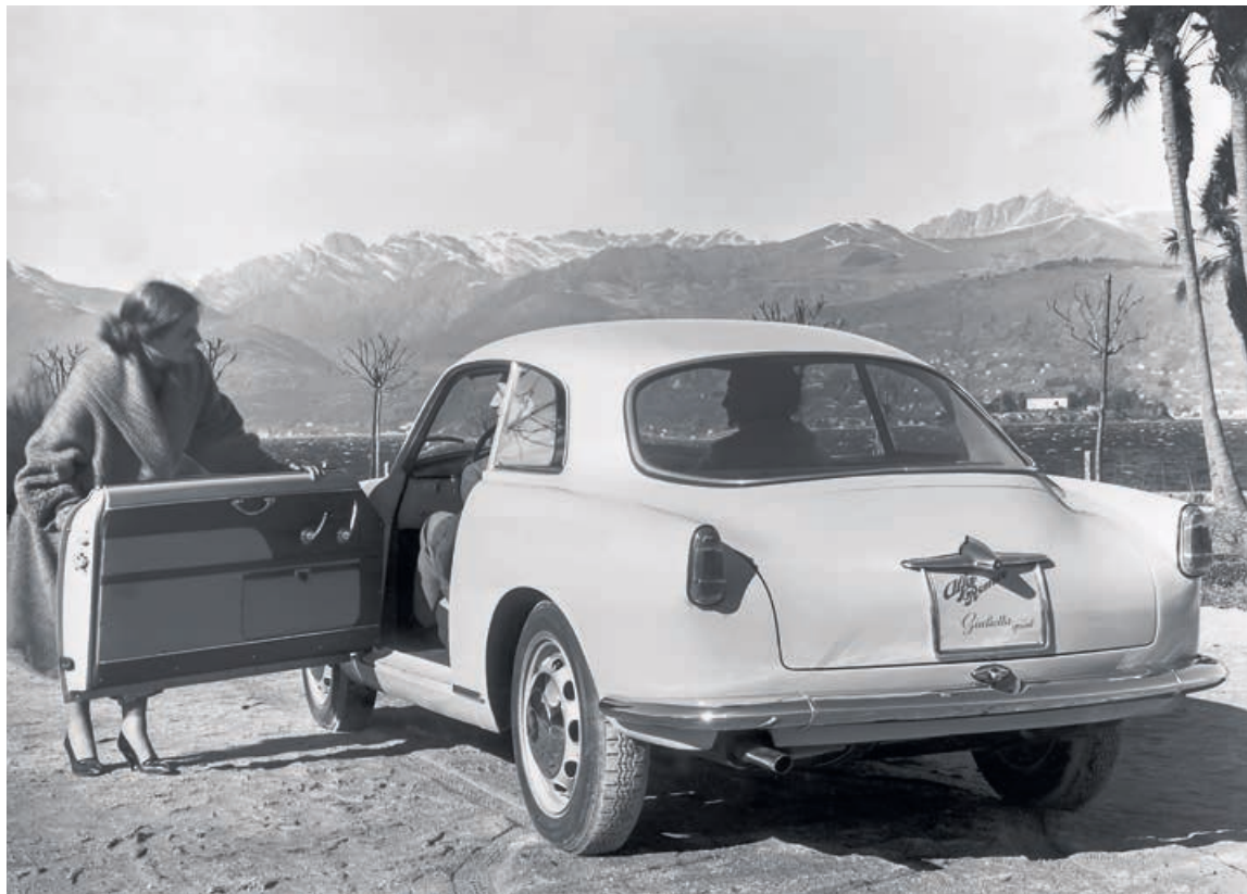
Le versioni di serie saranno consegnate a partire dai primi giorni del '55. Nell'esemplare dell'immagine in alto si notano i cerchi Fergat con il bordo arrotondato, tipici del primo anno di produzione. Una rottura durante la Mille Miglia spinse a riprogettarli per evitare di minare la sua proverbiale tenuta di strada. I nuovi cerchi, nell'immagine sotto, appaiono nel 1956 con il soprannome di "cerchi Buticchi", come il pilota che ebbe l'incidente Nel quale si ruppe uno di quelli del primo tipo.
