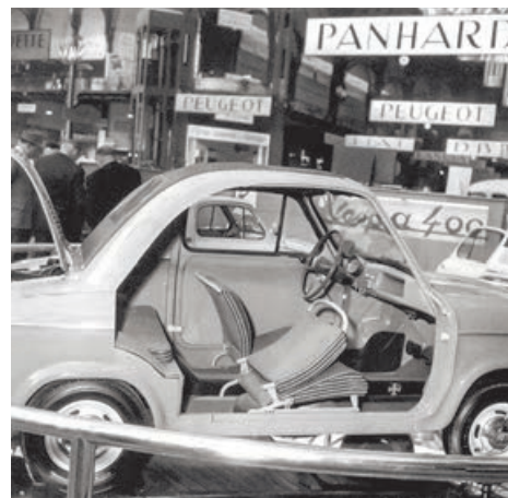
Sopra, una Vespa 400 senza fiancate al Salone di Parigi del 1957, quando viene presentata al pubblico. Si notano ancora i sedili con struttura tubolare a vista e rivestimenti in tessuto. Sotto, lo schema sospensivo a 4 ruote indipendenti.
