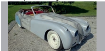
Jaguar XK120 DHC , anno 1953, guida a sinistra, scocca lattanata, passata con il primer e pronta alla verniciatura. Sono stati eseguiti vari lavori sulla vettura ed è stato rifatto il motore.
