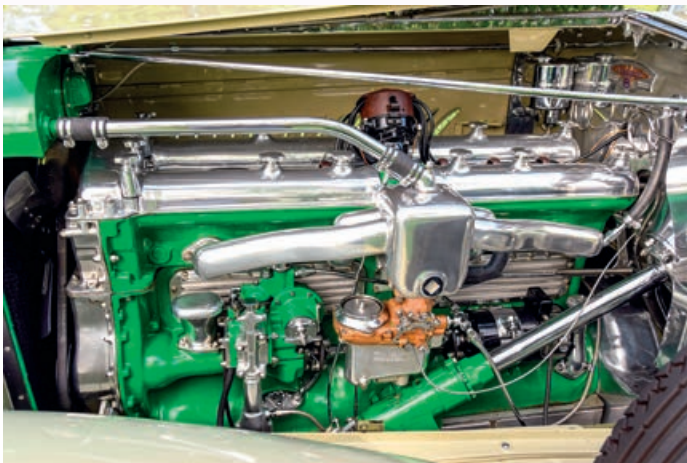
Il motore J 354 scintillate di metallo lucido e vernice verde. Il carburatore con flusso dal basso, che è sotto i collettori, sarà presto spostato sopra, dotato di un filtro dell'aria per aumentare l'affidabilità e la durata.
