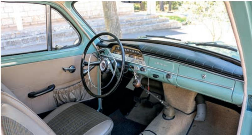
Gli interni hanno parti in comuni con la berlina Amazon e hanno la parte superiore in materiale imbottito antiurto. Sotto, la strumentazione con tachimetro "a nastro" è la stessa del resto della Gamma.
