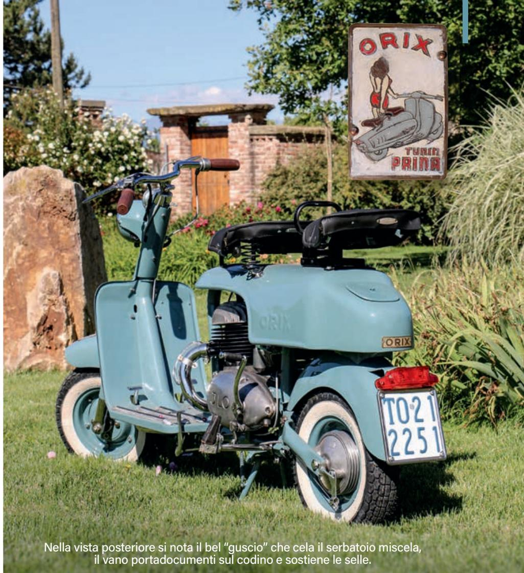
Nella vista posteriore si nota il bel "guscio" che cela il serbatoio miscela, il vano portadocumenti sul codino e sostiene le selle.
