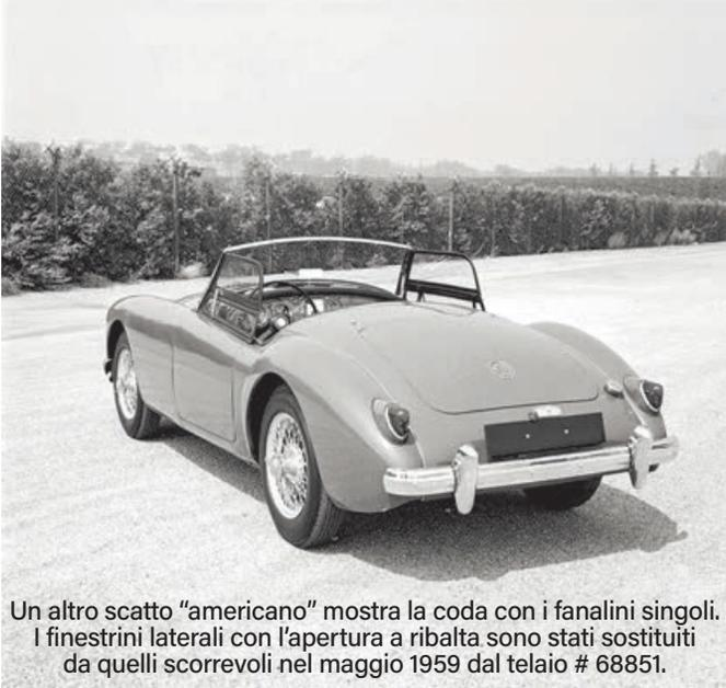
Un altro scatto "americano" mostra la coda con i fanalini singoli. I finestrini laterali con l'apertura a ribalta sono stati sostituiti da quelli scorrevoli nel maggio 1959 dal telaio # 68851.
