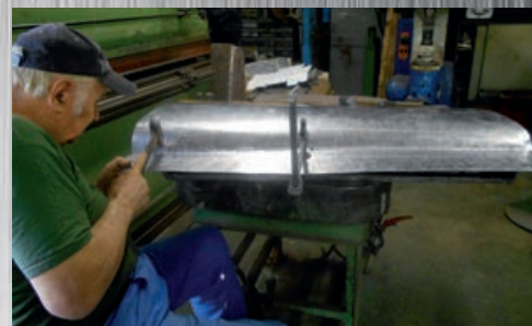
Costruzione fodero portiera in alluminio
