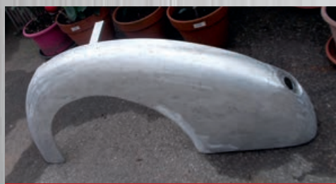
Costruzione in alluminio parafango posteriore Lancia Aprilia cabriolet
