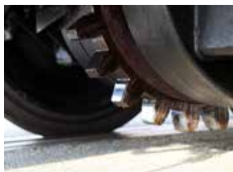
La ruota dentata inglobata nel carrello delle motrici. A destra, la rotaia dentata che la ruota delle motrici arpiona per superare elevate pendenze.
