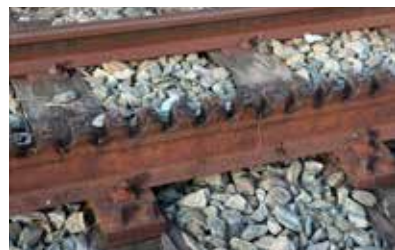
La ruota dentata inglobata nel carrello delle motrici. A destra, la rotaia dentata che la ruota delle motrici arpiona per superare elevate pendenze.
