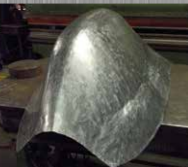
Ricostruzione cupolino posteriore auto Formula 3
