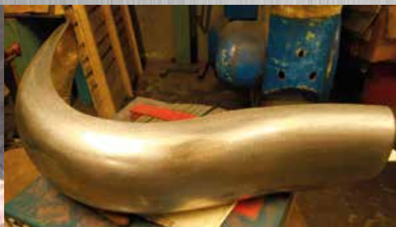
Costruzione cantonale paraurti anteriore Mercedes 300 SL ali di gabbiano in ottone pronto per essere ramato e cromato
