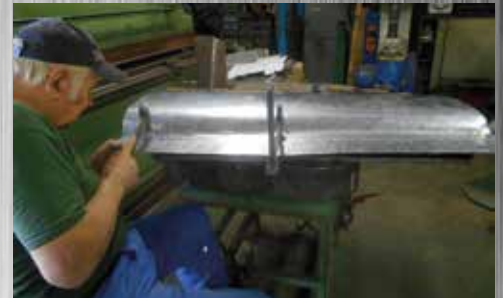
Costruzione fodero portiera in alluminio
