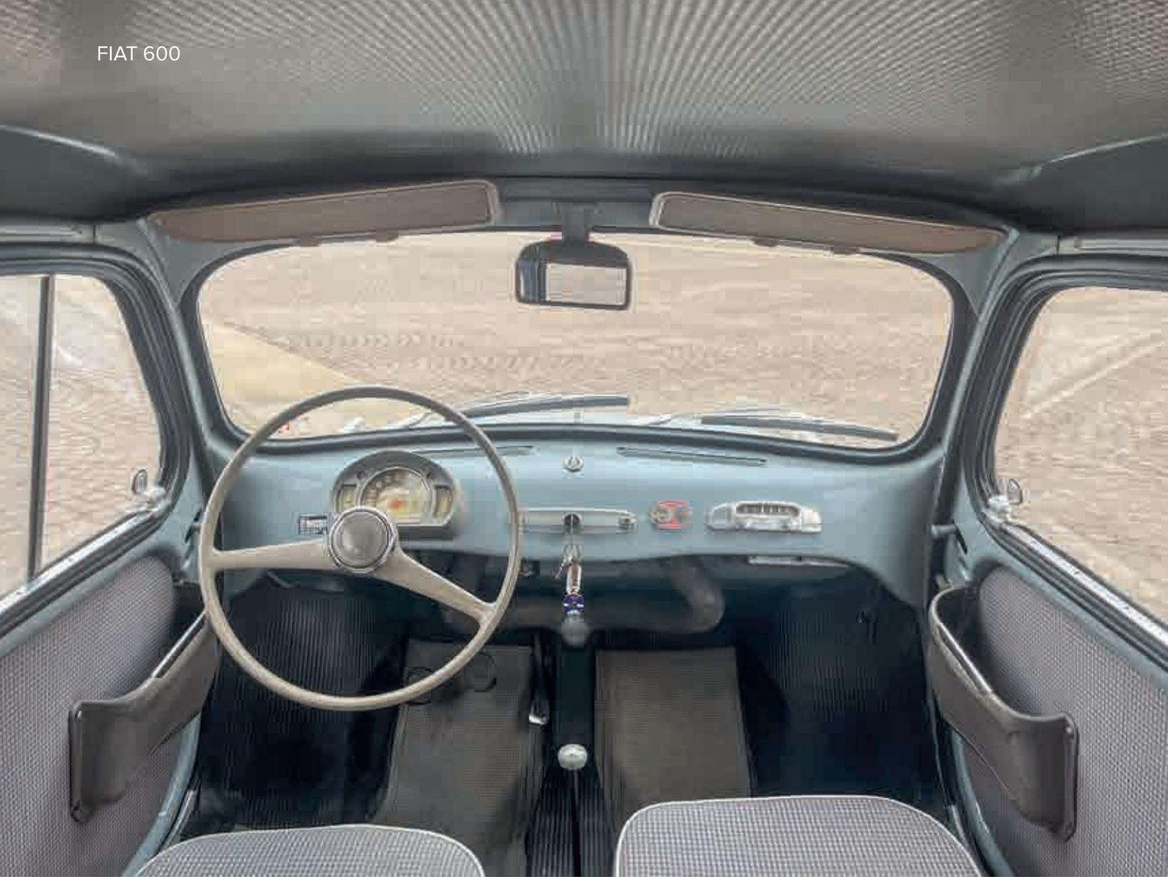
Sopra, il cruscotto e l'interno della prima serie, da notare la rarissima cornice in plastica degli interruttori e la radio dell'epoca Voxson. Sotto, la versione con tetto apribile del 1957 con i rostri cromati e le coppe ruota di nuovo disegno.
