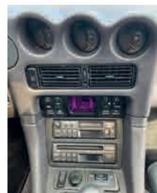
I comandi di climatizzazione e impianto stereo sembrano quelli dell'Enterprise, i tre strumenti al centro indicano la pressione di sovralimentazione, la pressione olio e la temperatura del liquido refrigerante.
