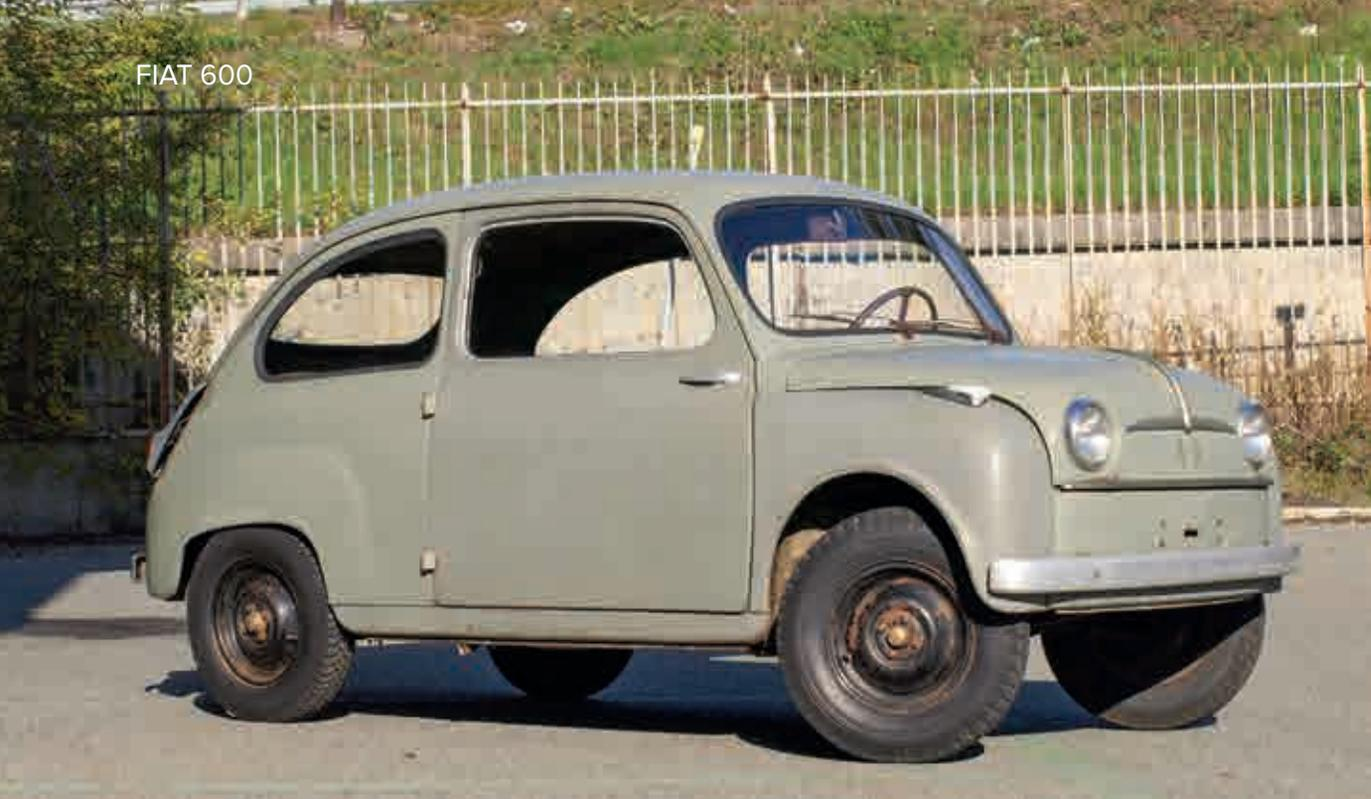
Il prototipo della 600 con motore bicilindrico, conservato ed attualmente custodito all'Heritage Hub di Torino: si può notare il frontale ancora molto diverso da quello definitivo.
