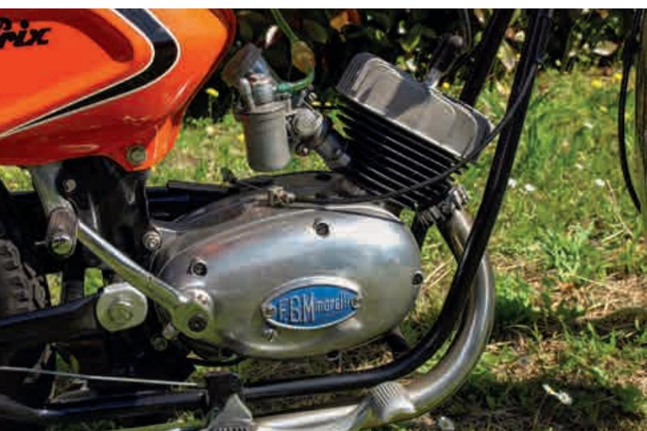
Da notare la forcella con molle a vista e i motivi neri su serbatoio e scatola portaoggetti che ne aumentano ulteriormente l'aggressività. A sinistra, il mitico motore Minarelli; in primo piano la leva per l'avviamento e quella del freno, posizionate sulla destra.
