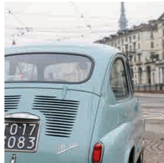
La grigliatura del posteriore della prima serie ha 15 feritoie per lato, sulla D diventeranno 18 per aumentare la capacità di raffreddamento. Da notare il tipico fanalino della prima serie, monocolore.
