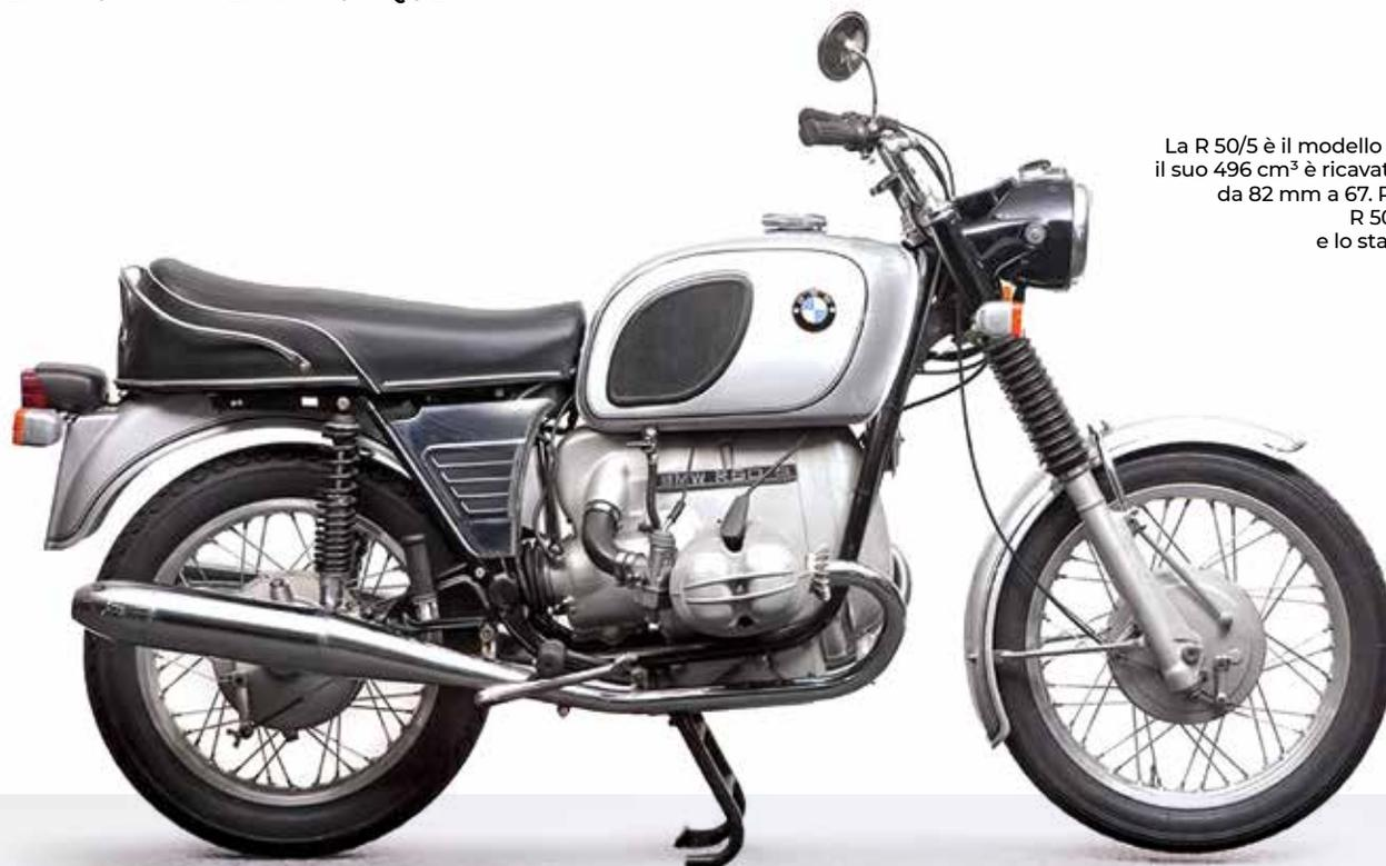
La R 50/5 è il modello d'attacco della gamma: il suo 496 cm<sup>3</sup> è ricavato riducendo l'alesaggio da 82 mm a 67. Rispetto alla precedente R 50 S ha 3 CV in meno (32) e lo starter elettrico è optional.
