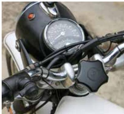
Il faro anteriore è più grande e ingloba sempre la strumentazione, però totalmente rivista, della Motometer, composta da contachilometri, contagiri e batteria di spie.
