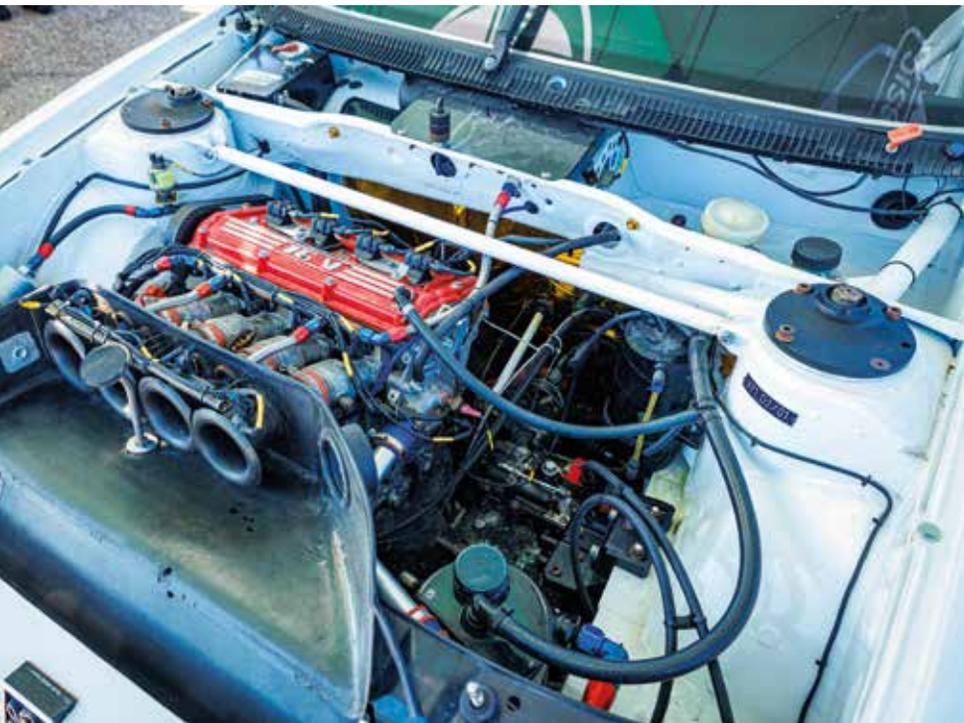
Il mitico 1.9 che ha motorizzato le "cattivelle" Peugeot e Citroen tra gli anni '80 e '90 con testata bialbero a 4 valvole per cilindrico, qui in configurazione da corsa e potenza da 290 CV. Da notare i condotti di aspirazione collocati nell'airbox anteriore in carbonio. L'auto - numero di telaio #V21/D2/01 - è una delle cinque realizzate da Italtecnica per il Team Ufficiale. La sua prima uscita rimessa a nuovo è stata al Minardy Day a Imola nell'agosto 2024.
