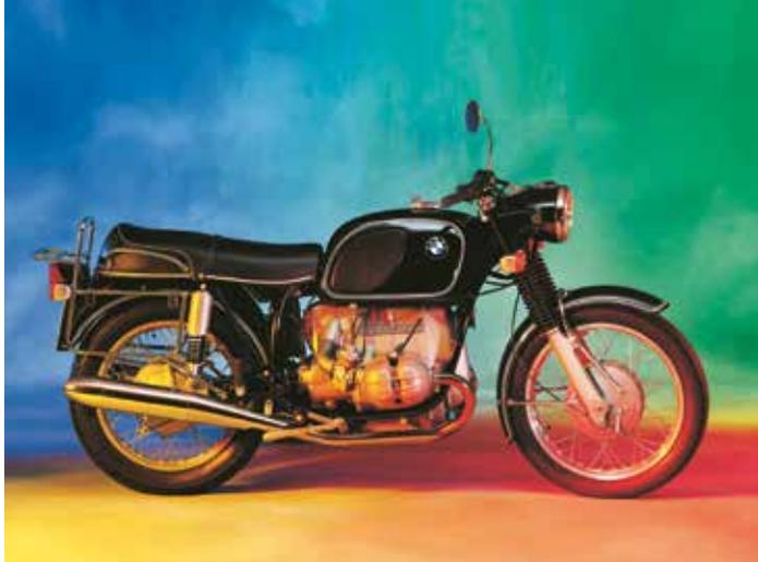
La R 75/5 sarà il modello trainante della gamma. Il telaio nuovo in tubi di acciaio più piccoli ma più rigidi è alleggerito di 5 kg. Nel 1972 arriva il modello con passo allungato di 5 cm (sotto). Si riconosce per le scritte a fondo nero (nell'immagine la "cadetta" R 60/5). Il serbatoio base è da 18 litri.
