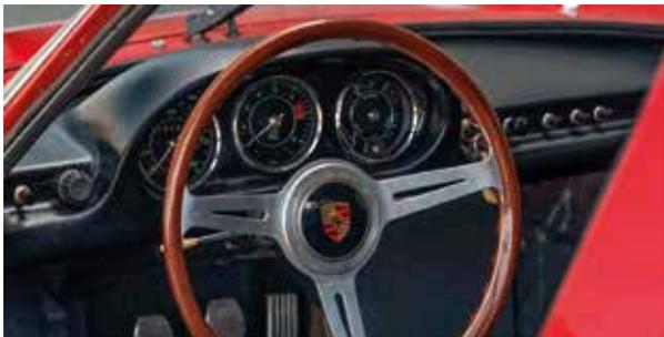
La #904-044 nelle condizioni in cui è oggi. A parte il rosso (la macchina è nata argento 6206), il resto è in ottime condizioni di originalità. A sinistra, la plancia della #904-044 con gli strumenti in linea e il volante a tre razze Les Leston, tipici della produzione di serie.
