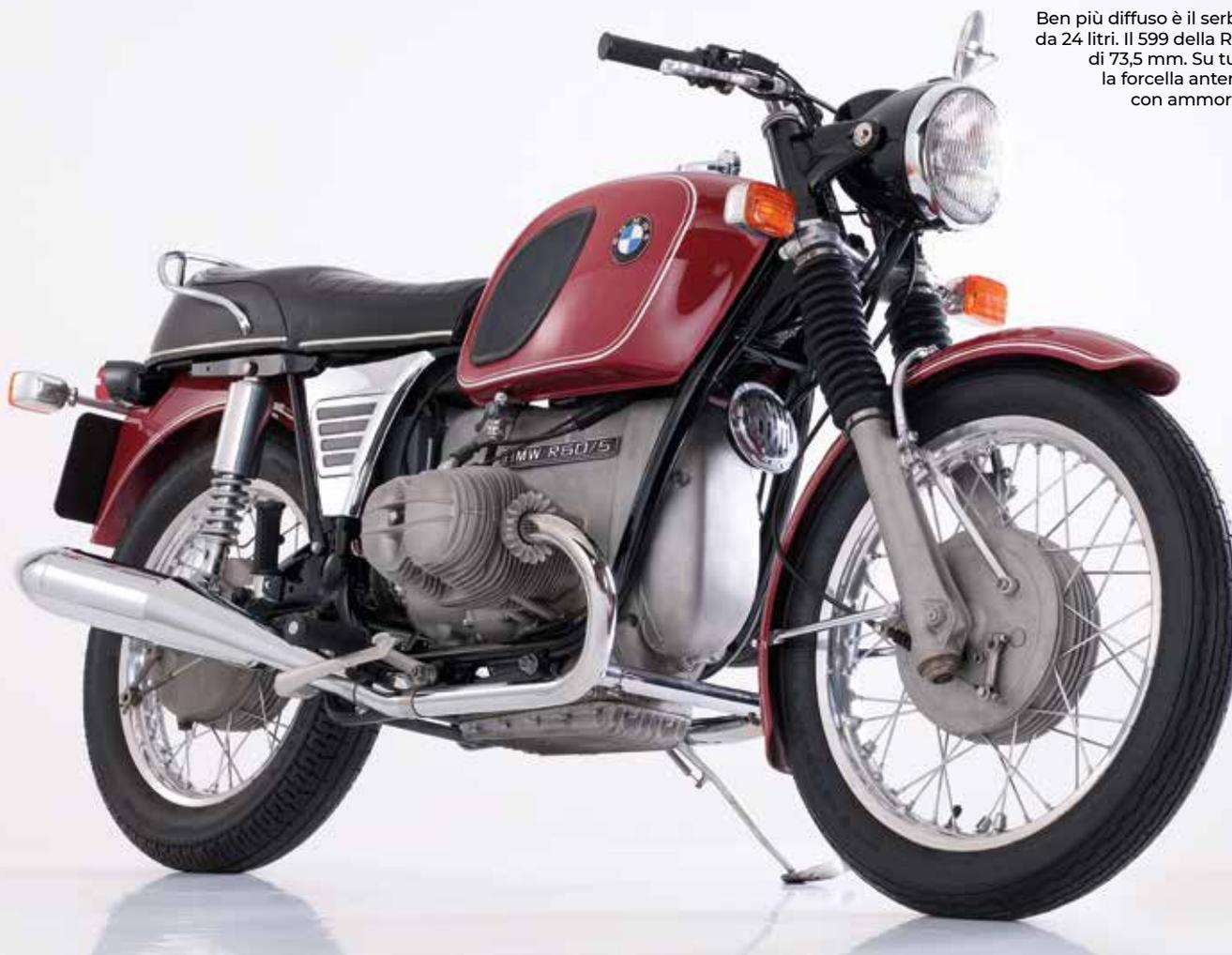
Ben più diffuso è il serbatoio maggiorato da 24 litri. Il 599 della R 60/5 ha alesaggio di 73,5 mm. Su tutte le "gamma/5" la forcella anteriore è telescopica, con ammortizzatori con corsa fino a 214 mm.
