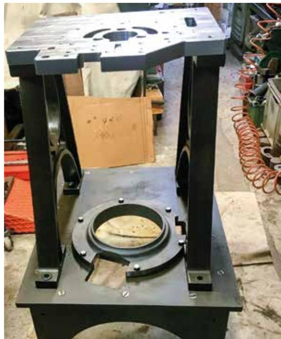
La "torretta" di sostegno dell'unico cilindro il cui pistone ha una un alesaggio "monstre" di 150 mm.
