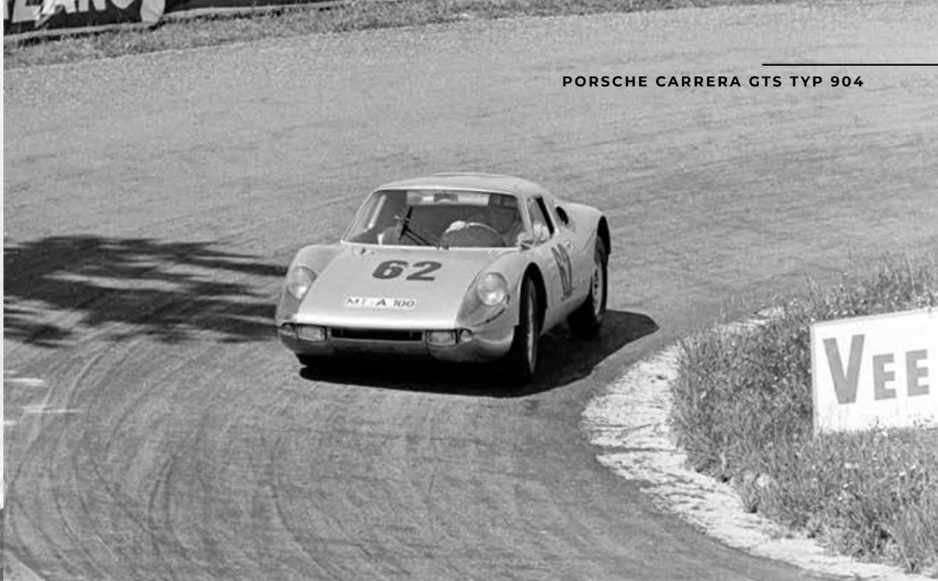
La #904-036 di Udo Schütz nella salita di Rossfeld il 7 giugno 1964. La scocca è nella configurazione standard con le porte lunghe, i finestrini scorrevoli e il tappo del rifornimento a destra. Sotto, Udo Schütz a Rossfeld il 13 giugno 1965 con la #904-036 di rifatta dopo l'incidente nella 1000 Km del Nürburgring con le porte corte, i finestrini scendenti, il tappo del rifornimento al centro e il foro per l'accesso rapido al bocchettone dell'olio.
