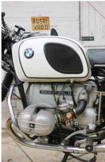
Il classico boxer bicilindrico 4T, a due valvole in testa per cilindro, aste e bilancieri e trasmissione cardanica - rivisto da Alexander von Falkenhausen e Hans-Günther von der Marwitz ispirandosi alla Norton Manx - sulla  $\frac{3}{4}$  di litro è dotato finalmente di due carburatori Bing di 32 mm, per la prima volta su una moto, in luogo dei precedenti a ghigliottina da 26 mm eroga 50 CV.
